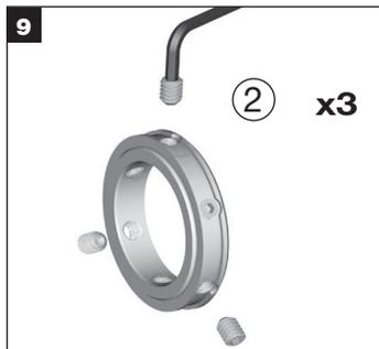
Die drei Ringschneide-Einstellschrauben (2) mit dem mitgelieferten Sechskantschlüssel gleichmäßig festziehen. **WICHTIG:** Nachdem alle Einstellschrauben von Hand festgezogen wurden, müssen sie mit einem Drehmomentschlüssel festgezogen werden:
