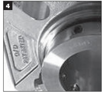
Die Pumpe wieder zusammenbauen und die erforderlichen Wellen- und Laufradadjustagen vornehmen. Das Laufrad kann jederzeit zurückgesetzt werden, solange die Zentrierklammern angebracht und die Dichtungseinstellschrauben gelockert sind, während die Welle verschoben wird.
